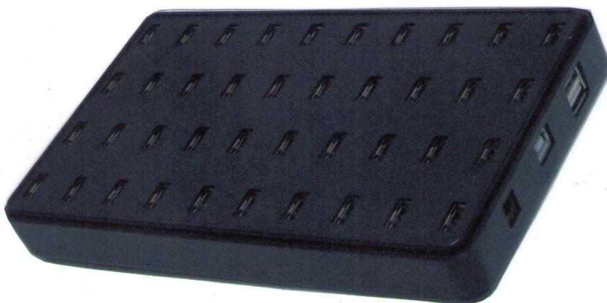
**Description:** concentrateur à 42 ports USB 2.0 - 40 ports en face supérieure - (entraxe transversal: 30 mm - entraxe longitudinal: 21 mm) - 2 ports en face arrière - trois voyants d'état
