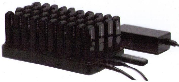
Ce concentrateur comporte 40 ports en face supérieure et deux ports additionnels en face arrière; il dispose de trois voyants d'état en face avant:
